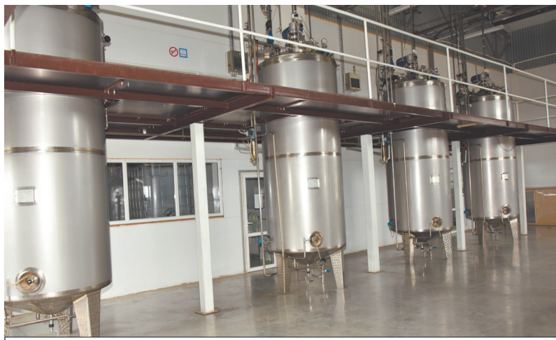
Биореакторы в производстве биологических средств защиты растений компании «Биотехагро»
